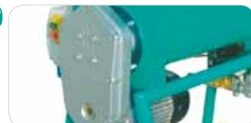
Motoriduttore IMER brevettato ad assi paralleli ad alta efficienza che migliora la trasmissione del moto. La configurazione con motore sotto la vasca riduce gli ingombri e non necessita di manutenzione e registrazione.
